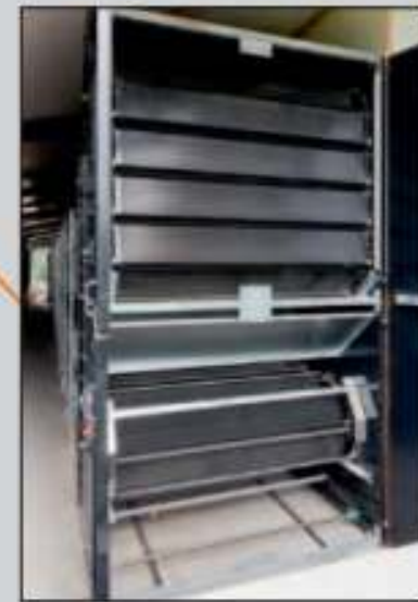
Plattenband-Trockner OptiPlate mit bis zu 2 x 5 Etagen
